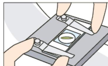
3. Lege den Objektträger mit dem Objekt auf den Objektisch. Achte darauf, dass das Objekt genau über der Öffnung ist.
