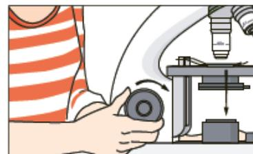
1. Fahre mit dem Grobtrieb den Objektisch ganz nach unten.
